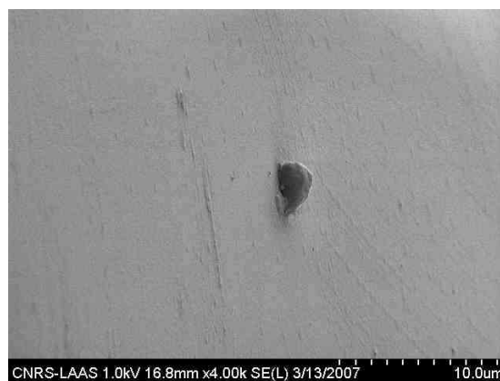
(e) Minisphère de 3,3mm de diamètre, échelle : 10 \mu\text{m}
