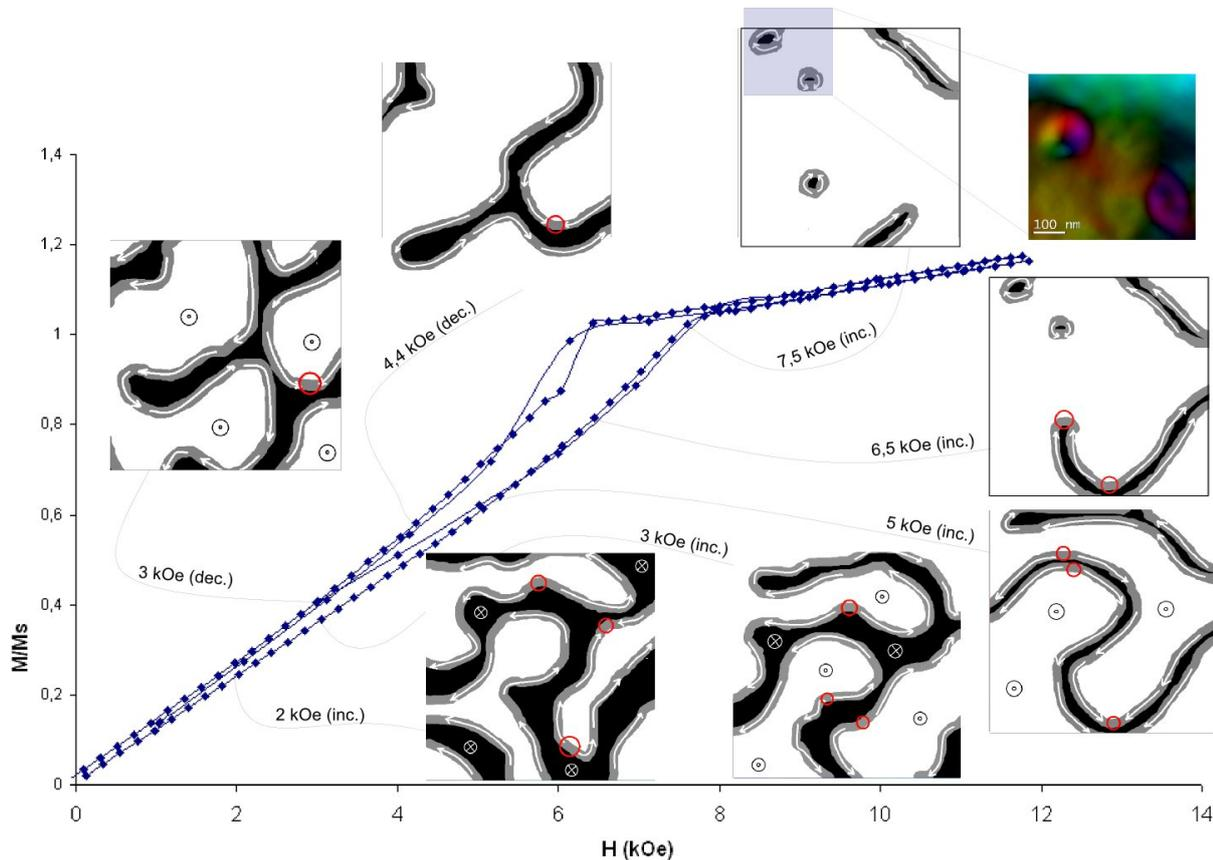
**FIG. III.29:** Demi-cycle d'aimantation mesuré par effet Hall. Pour différentes valeurs du champ magnétique des reconstructions par résolution de la TIE sont proposées. Les cercles sur les images indiquent la présence de VBL. *Images obtenues avec le microscope JEOL 3010*
