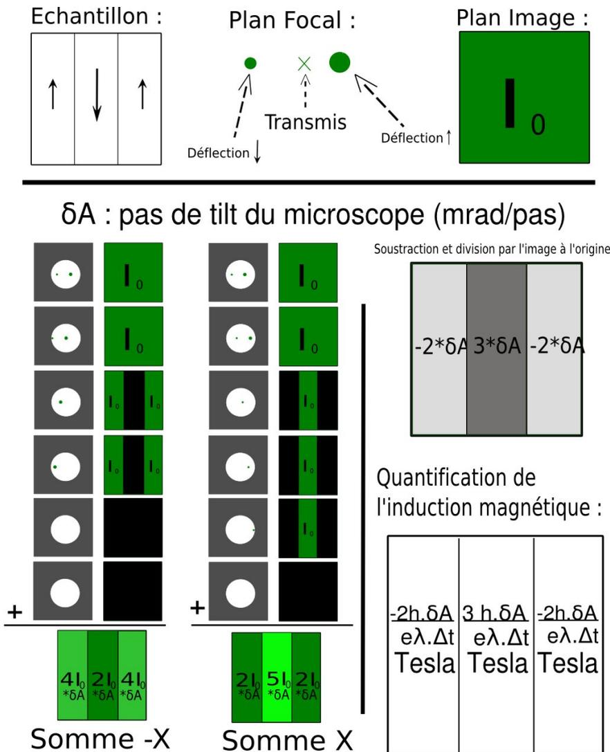
**FIG. II.11:** Schéma de principe de la quantification des cartographies obtenues par DPC. En haut, présentation d'un échantillon magnétique et son observation dans le plan focal et image. Colones de gauche : plans focal et image lors d'une acquisition DPC sur l'échantillon présenté au-dessus. Colone de droite : Résultat de l'acquisition DPC et quantification des valeurs.
