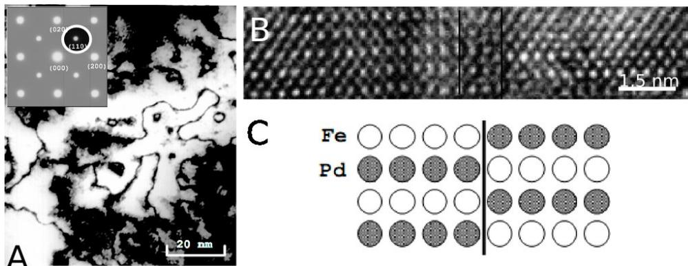
**FIG. III.5:** **A** Vue en champ sombre sur la tache (110) d'une vue plane de FePd. Les lignes noires sont des parois d'antiphase. L'insert correspond au cliché de diffraction. **B** Cliché en microscopie TEM Haute Résolution d'une paroi d'antiphase dans FePd. **C** Schéma de la structure d'une paroi d'antiphase. Images issues des thèses de V. Gehanno<sup>109</sup> et D. Halley<sup>106</sup>
