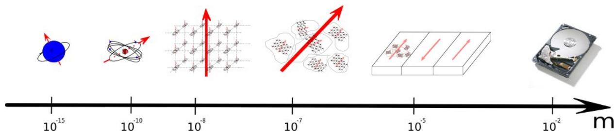
**FIG. I.3:** Échelle métrique du magnétisme. Du spin de l'électron (10<sup>-15</sup> m) à un disque dur en passant par le spin atomique (10<sup>-10</sup> m), le grain cristallin (10<sup>-8</sup> m) et les polycristaux ( $\mu$ m).
