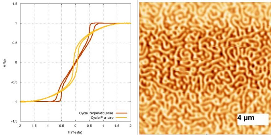
**FIG. III.7:** **A** Cycles d'hystérésis perpendiculaire (rouge) et planaire (jaune) obtenus par Effet Hall et VSM respectivement sur un échantillon bi-couche de  $FePd_{L1_0} \setminus FePd_2$ . **B** Image MFM obtenue sur le même système en champ nul.
