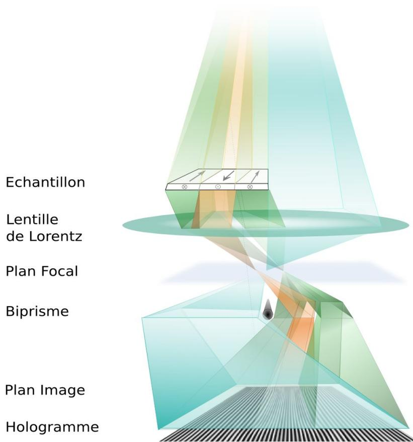
**FIG. II.17:** Description schématisée du chemin des électrons pour l'acquisition d'un hologramme en holographie *out-of-axis*. La superposition des deux faisceaux crée un réseau de franges d'interférences (simulation).
