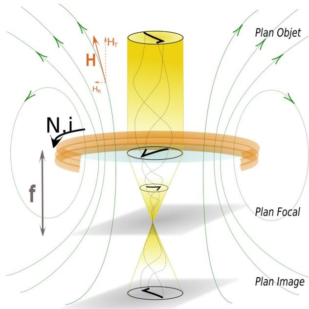
**FIG. II.1:** Schéma de principe de l'action d'une lentille électromagnétique. La bobine où circule le courant  $N.i$  produit un champ magnétique  $\vec{H}$  qui agit sur le faisceau d'électrons. On associe une distance focale  $f$  à la lentille électromagnétique. On voit que l'image tourne entre le plan objet et le plan image (la vue est volontairement idéalisée pour décrire à la fois géométriquement et techniquement le fonctionnement de la lentille).
