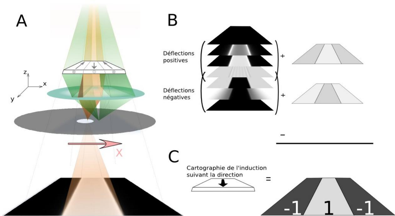
**FIG. II.9:** Principe d'une acquisition en Differential Phase Contrast. **A.** En mode Foucault, le diaphragme est balayé dans le plan focal pour effectuer des acquisitions sélectionnant différentes déflexions. Toutes les images (**B**) permettent ensuite, par addition, de remonter à la composante magnétique, perpendiculaire à la trajectoire du diaphragme (**C**).
