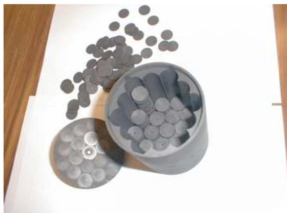
**FIGURE 2.9:** Photographie des pastilles de carbure d'uranium mise en place pour la future cible SPIRAL2
