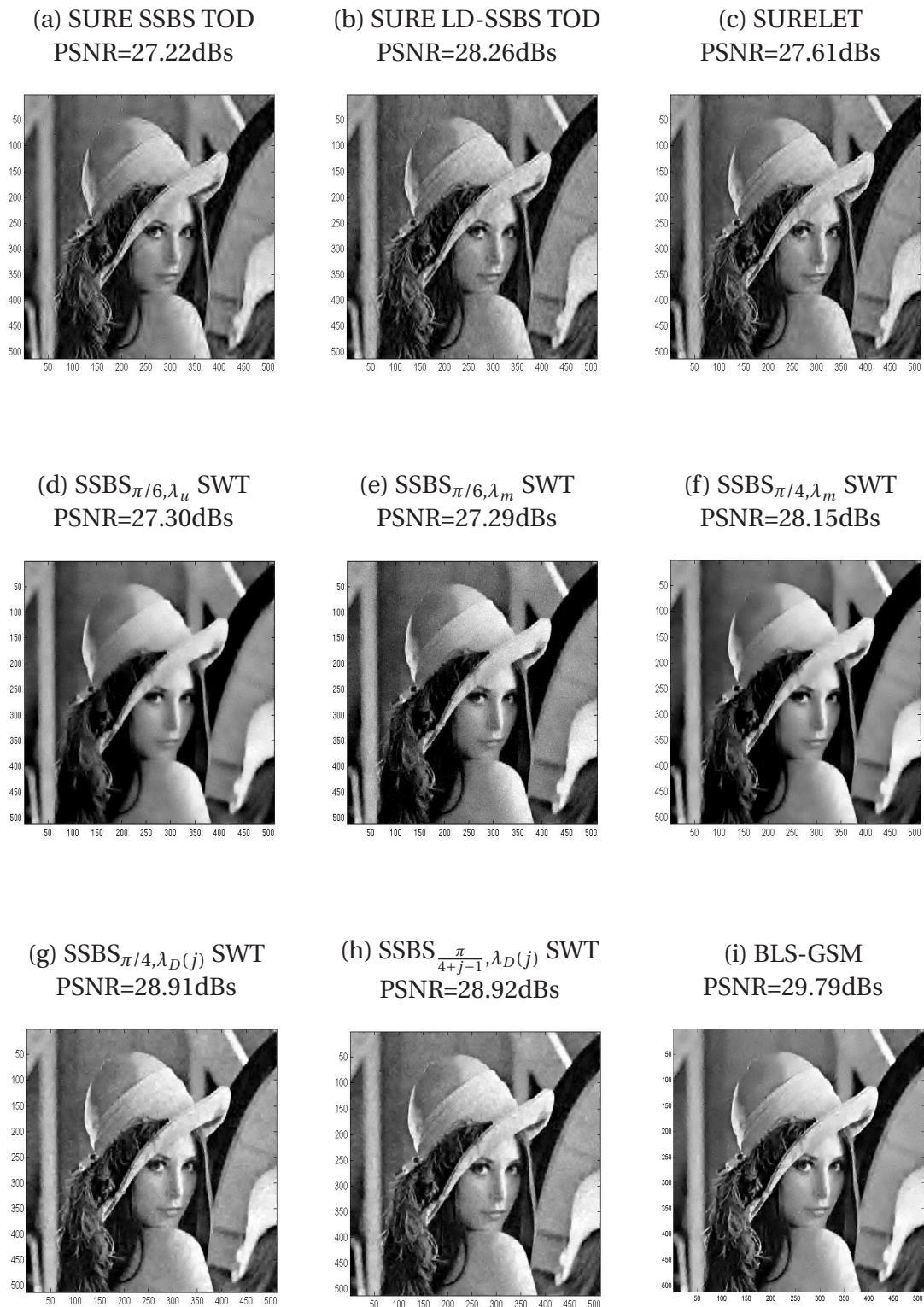
Figure 6.7 — Débruitage de l'image 'Lena' corrompue par du bruit additif blanc Gaussien d'écart-type \sigma = 35 par les méthodes BLS-GSM, SURELET et SSBS. Les niveaux de décomposition concernés sont j=1, 2, 3, 4 .
