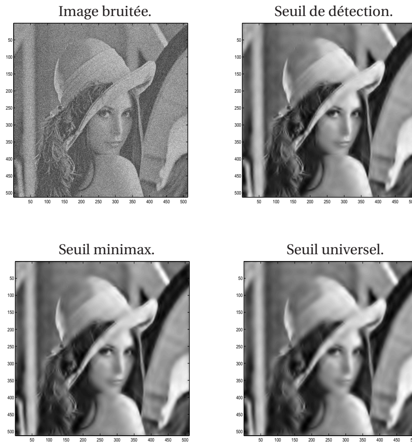
Figure 5.3 — Image bruitée et images débruitées de 'Lena', par seuillage doux avec les seuils de détection, minimax et universel (SWT - 'sym8' - J = 4 ). L'écart-type du bruit est \sigma = 36 .
