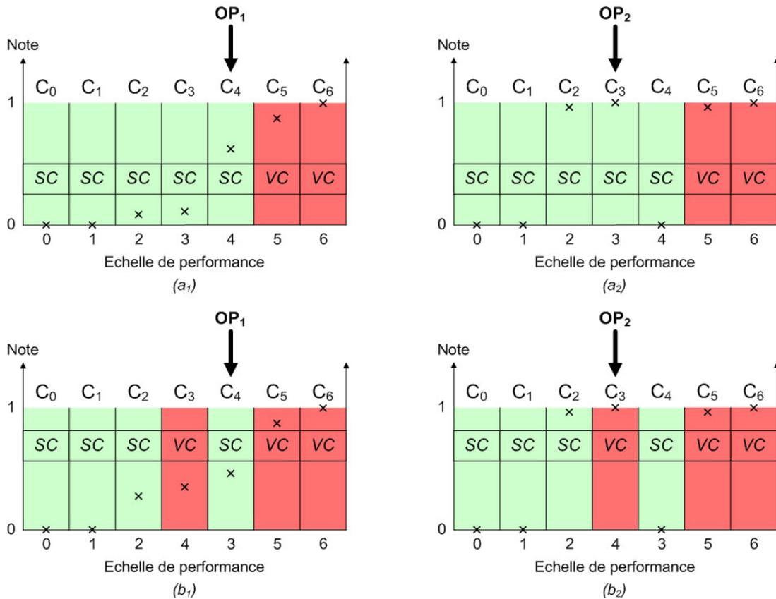
FIGURE 3.6 – Scénarios de prise de décision pour différentes politiques d'optimisation (gauche :  $OP_1$ , droite :  $OP_2$ ) avec (bas) ou sans (haut) erreurs dans l'échelle de performance
