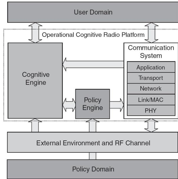
FIGURE 2.2 – Architecture haut-niveau d'une radio cognitive (extrait de [25])
