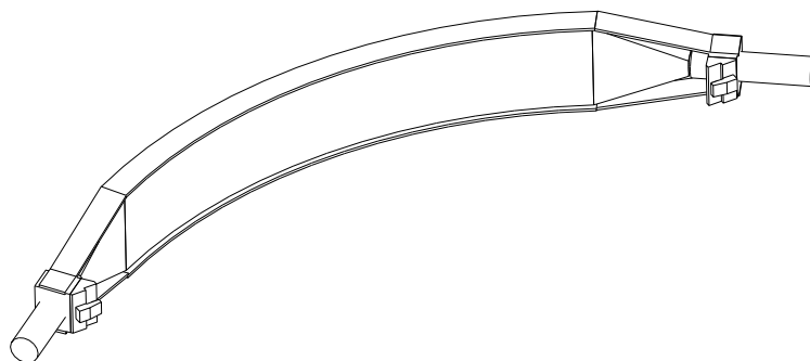
FIG. II.2 – Schéma en trois dimensions d'une latte de TONNERRE avec la présence d'un tube photomultiplicateur à chaque extrémité.
