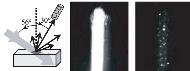
Figure IV.21 : Maximum et minimum de diffusion par un liquide diffusant éclairé en incidence oblique ( 30^\circ ) et observé avec un angle de diffusion de 30^\circ . Les niveaux moyens de gris sont de 254 sur l'image de gauche (pixels saturés) et de 37 sur l'image de droite.
