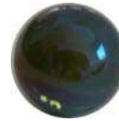
Bille agitée pendant le dépôt : Uniformément recouverte
