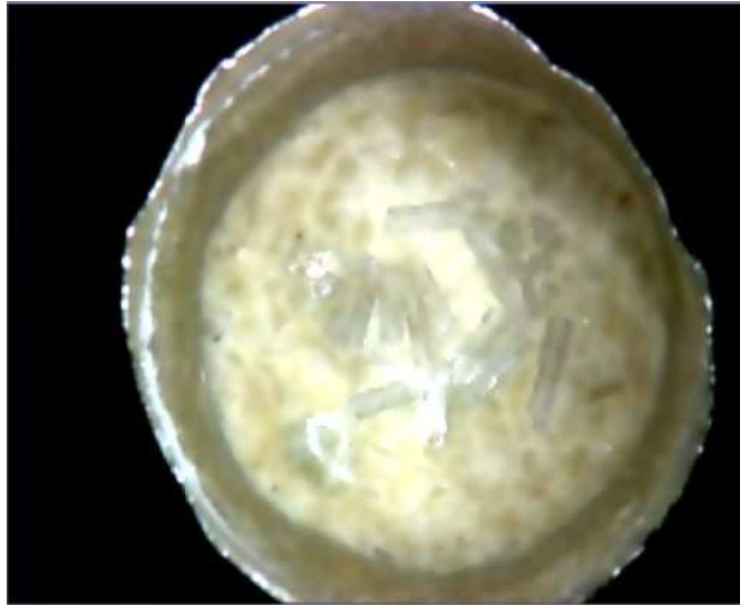
Figure III.B2 : Photographie des cristaux de \text{NaY}(\text{PO}_3)_4 à l'intérieur du creuset en platine.
