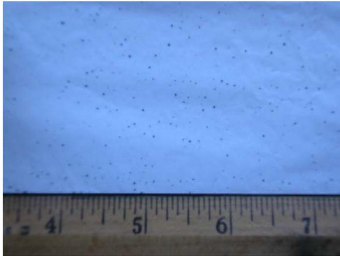
FIG. A.8 – Photo du papier de soie utilisé pour quantifier le nombre de contacts entre le disque et le plateau. Chaque point noir correspond à un contact.
