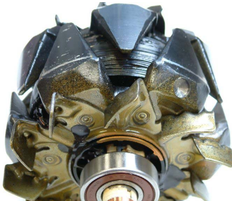
Figure IV.7 : Vue de l'alternateur à griffes
