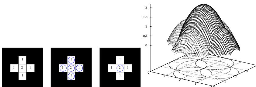
FIG. 7.15 – De gauche à droite, une forme discrète  $X$  et sa transformée en distance euclidienne ; les 5 centres des boules dont le dôme touche l'enveloppe supérieure des paraboloides, dessinée à droite ; l'axe médian discret est formé du seul point central encerclé ; forme continue  $Y$  et enveloppe supérieure des paraboloides bordant la forme  $\hat{Y}$ .
