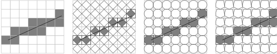
FIG. 4.5 – Quelques exemples de modèles analytiques : supercouverture, naïf fermé, pythagoricien et engendré par un pentagone.
