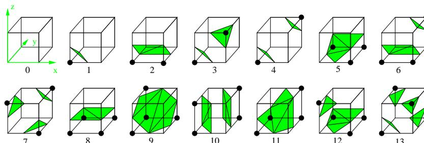
FIG. 6.10 – Les 14 configurations de l'algorithme initial des *Marching-Cubes*.
