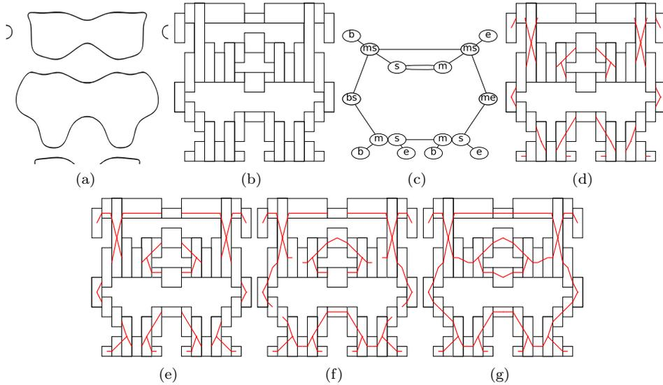
FIG. 6.5 – Tracés de la fonction  $x^2 + y^2 + \cos(2\pi x) + \sin(2\pi y) + \sin(2\pi x^2) \cos(2\pi y^2) = 1$  sur  $[-1, 1]^2$  (exemple de [Sny92]) : (a) approximation du tracé, (b) cellules résultantes de l'approximation en intervalles et du recodage, (c) le graphe de REEB associé. Les figures (d) à (g) illustrent les étapes de la reconstruction polygonale partant des nœuds du graphe de REEB.
