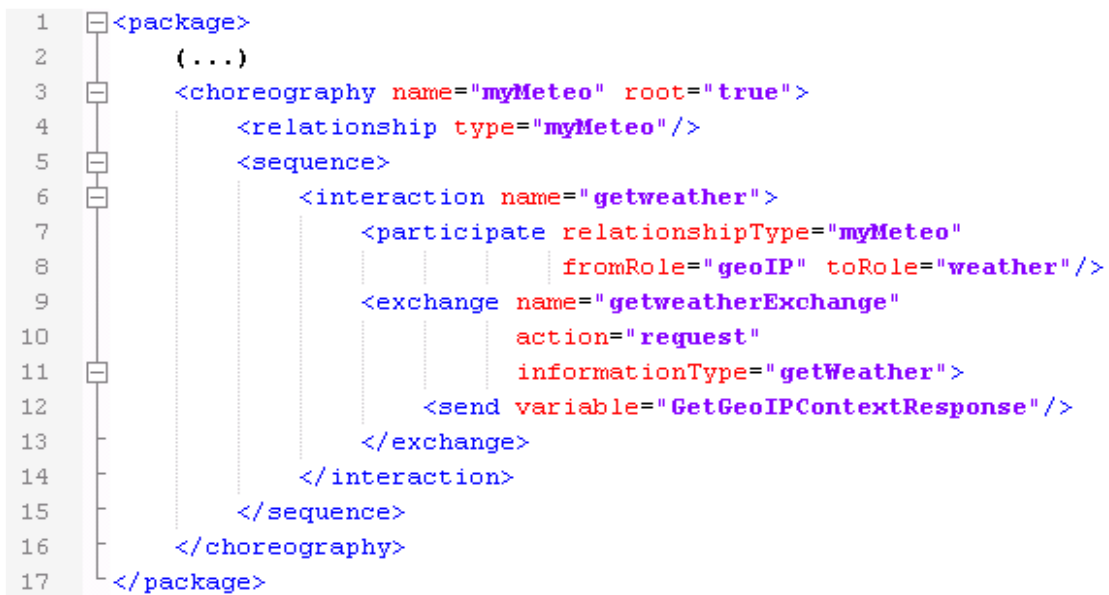
Figure 4.11 Extrait de l'interaction entre les deux services Web GeoIPService et GlobalWeather pour implémenter la composition myMeteo .
