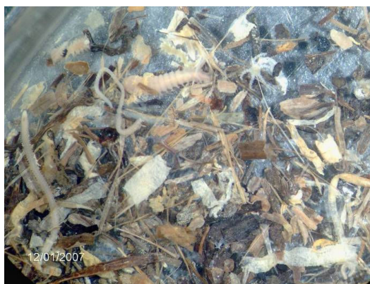
Figure II 10 : Photo des refus de tamis sous la loupe binoculaire.
