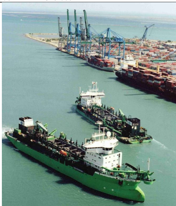
Figure II 3 : Photo aérienne des dragues en cours d'opération dans la darse 2. À gauche, drague vide. À droite, drague pleine. Source PAM.
