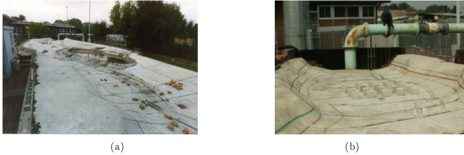
Figure 9.1 – (a) Vue générale de la zone urbaine dans le modèle réduit de la plaine du Toce (Alcrudo et al. , 2002), (b) partie amont du modèle réduit avec les blocs disposés en configuration alignée.
