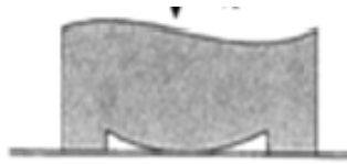
Figure 2.22 : d'après [36]. Roof collapse : contact non désiré entre le timbre et le substrat.
