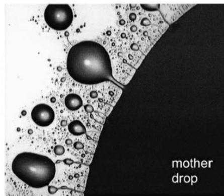
FIG. 1.22 – Ejection de gouttes satellites lors d'une expérience d'électromouillage [104]. Au delà de la tension de saturation, le liquide éjecte des gouttelettes.
