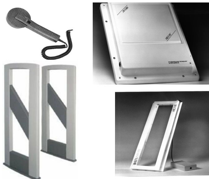
Fig.3.17. Exemples d'antenne de lecteur RFID [Traçabilité-http]
