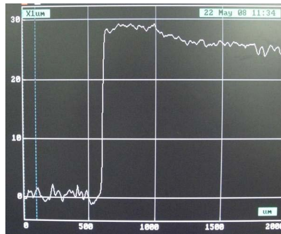
Fig. 2.14 Mesure de l'épaisseur de cuivre sur un substrat FR4 à l'aide d'un profilomètre mécanique ( \approx 25\mu\text{m} ).
