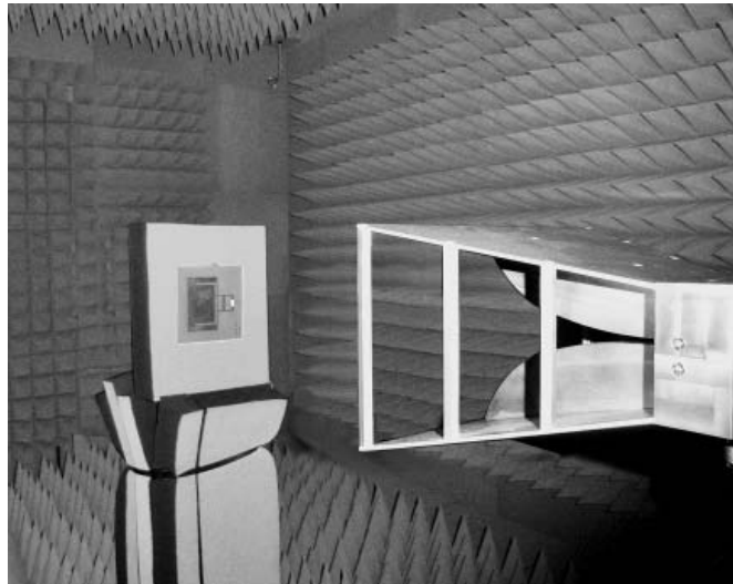
Fig. 4.59 Mesure de la section radar en chambre anéchoïque.
