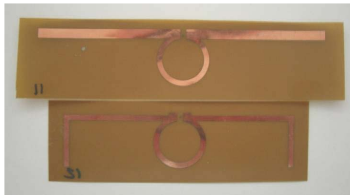
Fig. 5.25 Réalisations de l'antenne dipôle adaptée par couplage inductif et de l'antenne dipôle repliée adaptée par couplage inductif.
