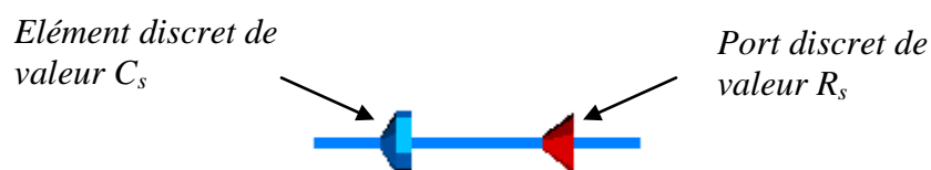
Fig. 4.45 Représentation sous CST Microwave Studio de la puce RFID.
