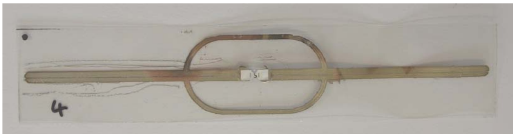
Fig. 6.31 Réalisation de l'antenne de tag RFID par impression jet d'encre sur PET (Propriété Ardeje - LCIS).
