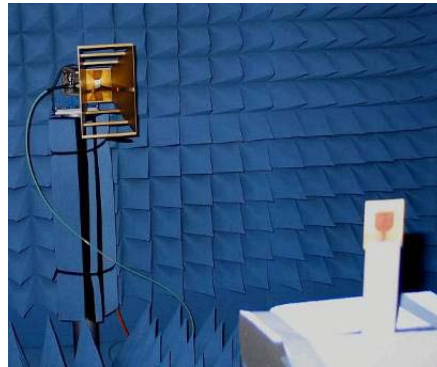
Fig. 3.19 Mesure de diagramme de rayonnement en chambre anéchoïque.
