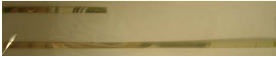
Fig. 6.18 Lignes microstrips 50\ \Omega imprimées sur PET avec l'encre A (5 et 14 cm) (Propriété Ardeje - LCIS).
