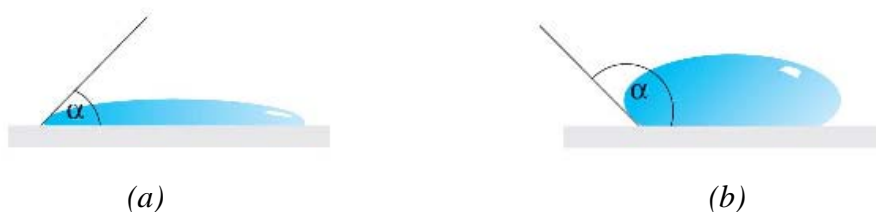
Fig. 6.11 Représentation de l'adhésion de l'encre en fonction de la tension de surface de cette dernière et du support. (a) Tension de surface du support inférieure à celle de l'encre. (b) Tension de surface du support supérieure à celle de l'encre.
