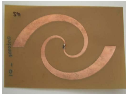
Fig. 4.26 Réalisation de l'antenne spirale.
