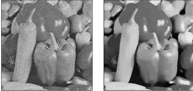
FIG. 5.2 – Restauration d’image automatique par minimisation de la variation totale avec la méthode proposée dans [118] (à gauche, l’image bruitée; à droite, l’image restaurée). L’échelle des objets à enlever était fixée à 1 pixel.
