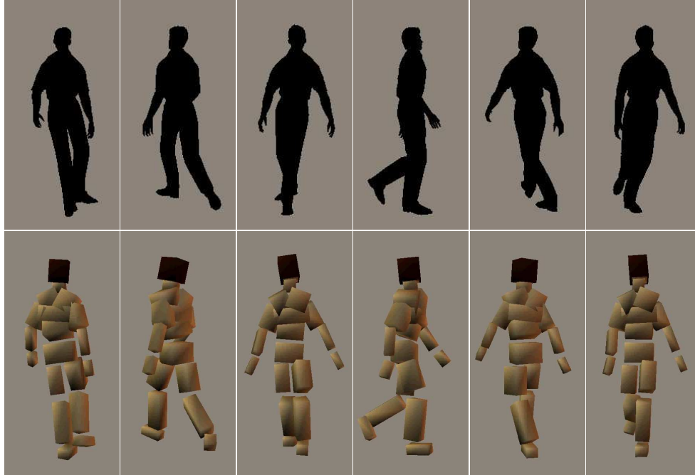
FIG. 4.4 – Quelques exemples des poses reconstruites par la méthode silhouette dynamique. En comparaison avec la méthode statique (voir la figure 4.3), toutes les reconstructions sont correctes. L'erreur moyen dans cette séquence de teste synthétique où le sujet marche dans une spirale décroissante est environ 4.1^\circ par degré de liberté.
