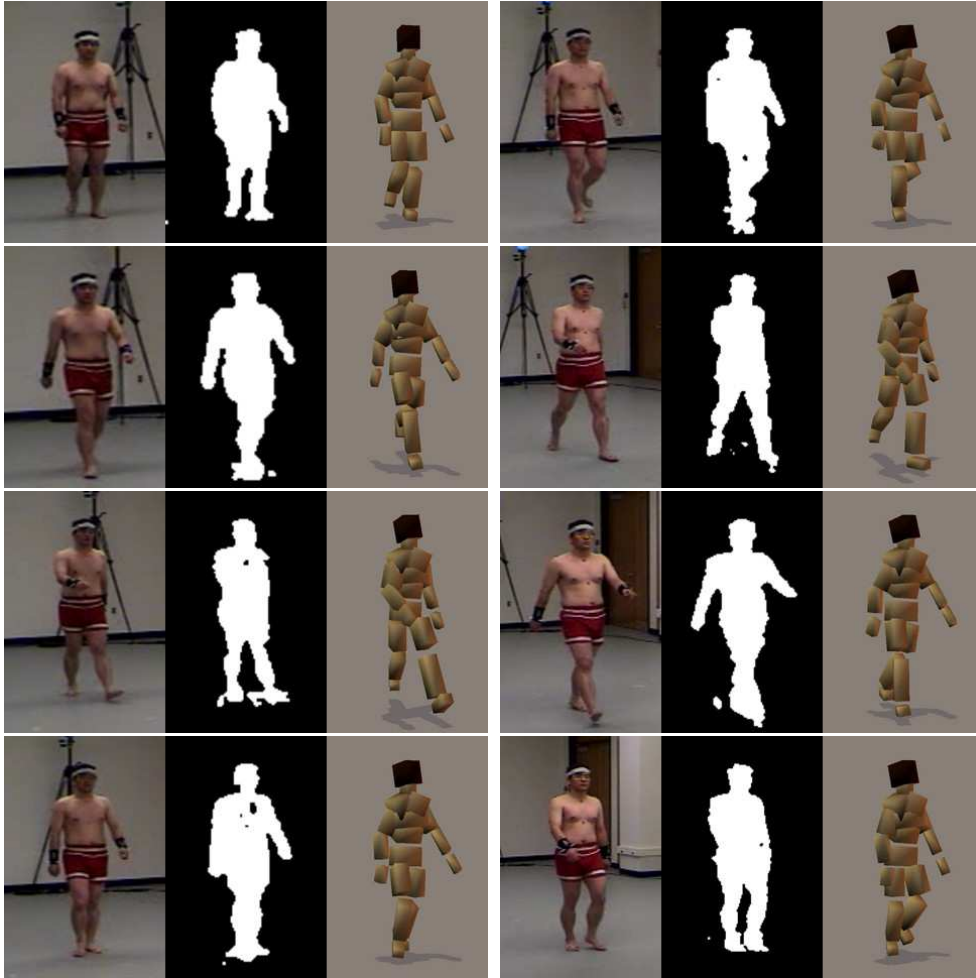
FIG. 4.5 – Quelques résultats de la méthode silhouette dynamique sur une séquence réelle (obtenue de http://mocap.cs.cmu.edu/ ).
