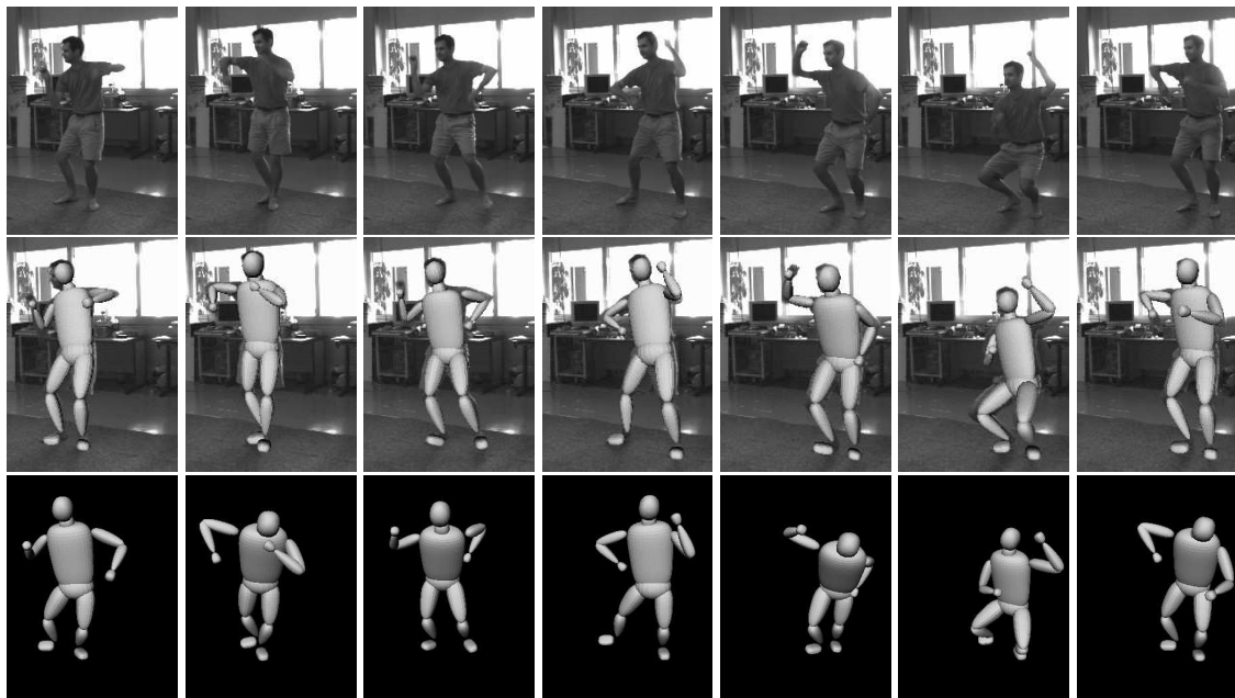
FIG. 2.8 – Le suivi « sauts cinématiques » sur une séquence de danse. Première ligne: images originales. Deuxième ligne: reprojexion du suivi dans l’image d’origine (le suivi est multi-hypothèses, mais seulement la meilleure configuration est montrée à chaque instant). Dernière ligne: une vue différente du mouvement reconstruit.
