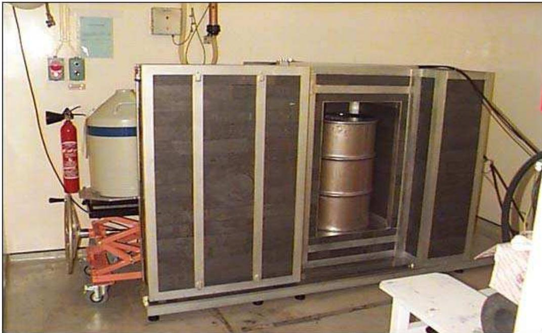
**Figure 11 : Cellule REGAIN instrumentée, dans sa casemate d'irradiation.**
