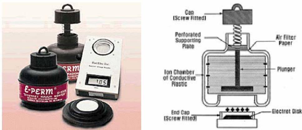
**Figure 4.18** : Principe de la chambre d'ionisation à Electret
