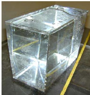
**Figure 1.12** : Fantôme  $30 \times 30 \times 15 \text{ cm}^3$  en PMMA
