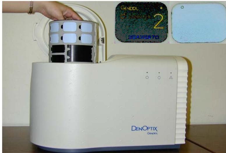
**Figure 2.16** : Système de détection et de lecture
