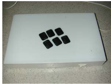
Figure 2.15 : Effaceur de l'énergie résiduelle des films photostimulables
