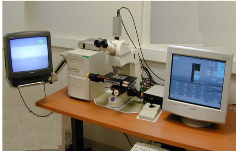
Figure 2.2 : Système d'exploitation des DSTN utilisé pour la numérisation et le comptage des traces alpha
