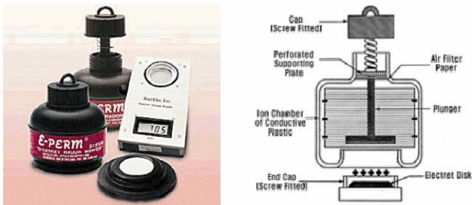
Figure 4.18 : Principe de la chambre d'ionisation à Electret
