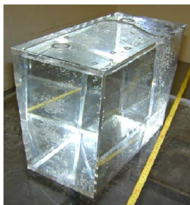
Figure 1.12 : Fantôme 30 \times 30 \times 15 \text{ cm}^3 en PMMA
