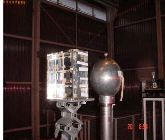
Figure 3.30a : Dosimètres exposés à 252 Cf modéré par D 2 O Figure 3.30b : Dosimètres exposés à 252 Cf modéré par D 2 O/Cd
