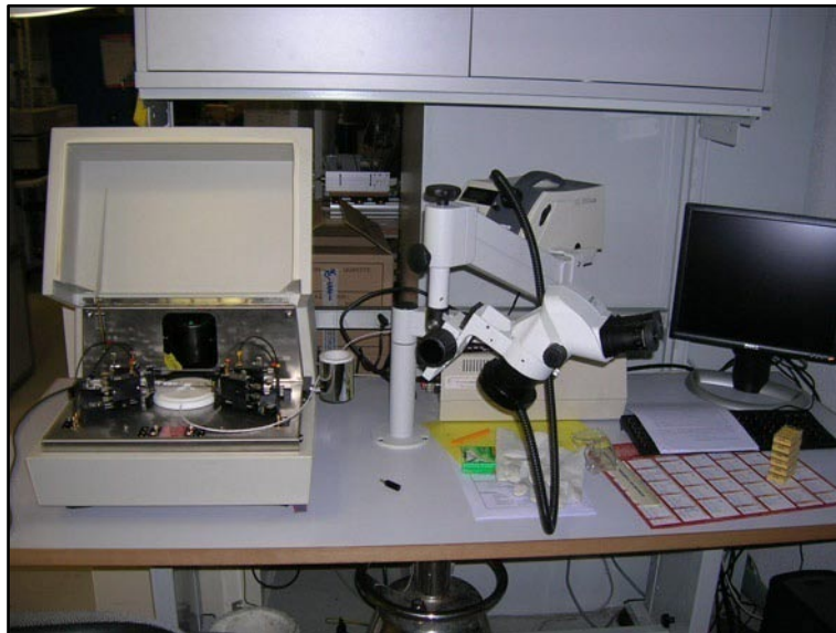
Figure 77 : Banc de mesure HL 5500 PC utilisé pour les mesures par effet Hall
