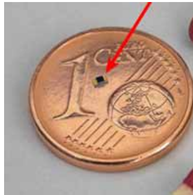
Figure 1.6 : Micropeltier sur un mécanisme de montre et sur une pièce de 1 centime d'Euros [micropelt.com]
