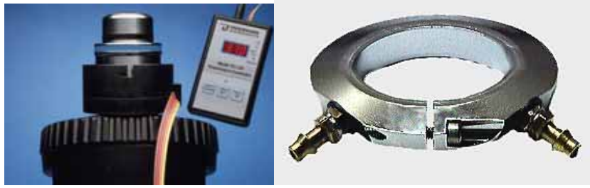
Figure 1.14 : Gauche : Objectif de microscope contrôlé en température par effet joule [Warner 2006] Droite : Collier pour objectif de microscope utilisant un circulateur d'eau. Contrairement à celui utilisant l'effet joule, ce collier permet de descendre en dessous de la température ambiante [bioptechs.com].
