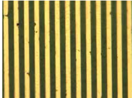
Figure B.3 : Piste de platine de 10µm de large, obtenue par photolithographie à basse température sur LDPE. Nous pouvons observer le manque d'homogénéité de la largeur des pistes
