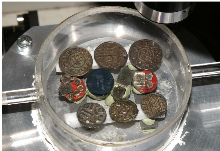
Figure 16 - Photographie de la cellule d'ablation contenant des monnaies d'argent.
