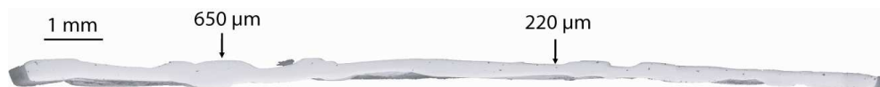
Figure 60 - Image d'une coupe de monnaie carolingienne par microscopie électronique à balayage en mode électrons secondaires.
