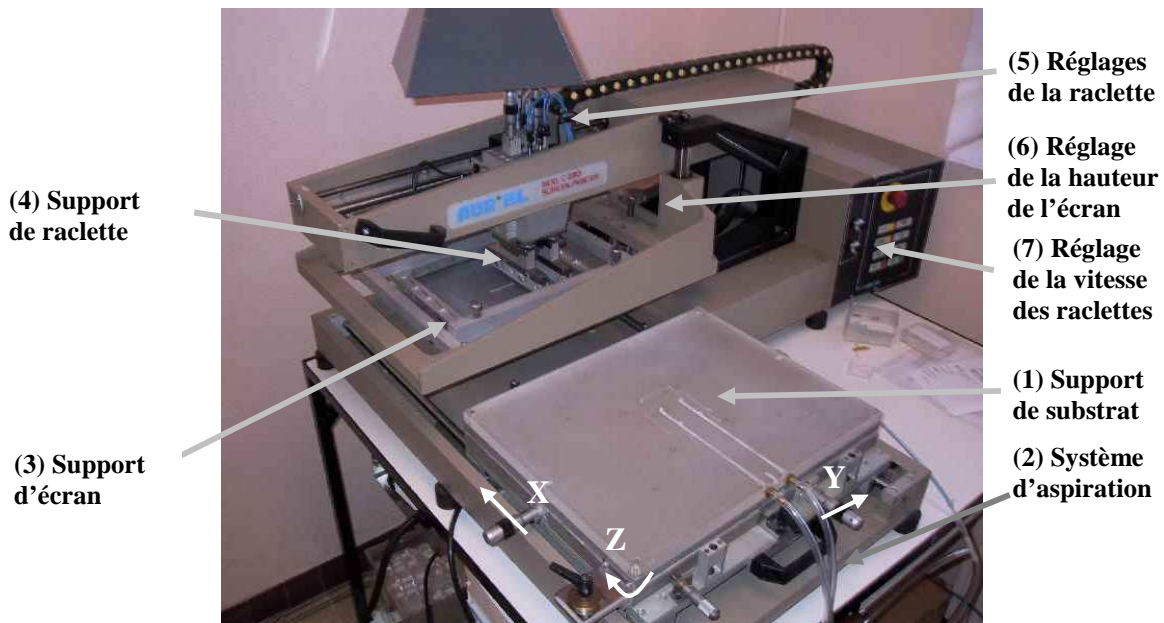
Figure II-16. Machine semi-automatique de sérigraphie « Aurel Model C890 »
