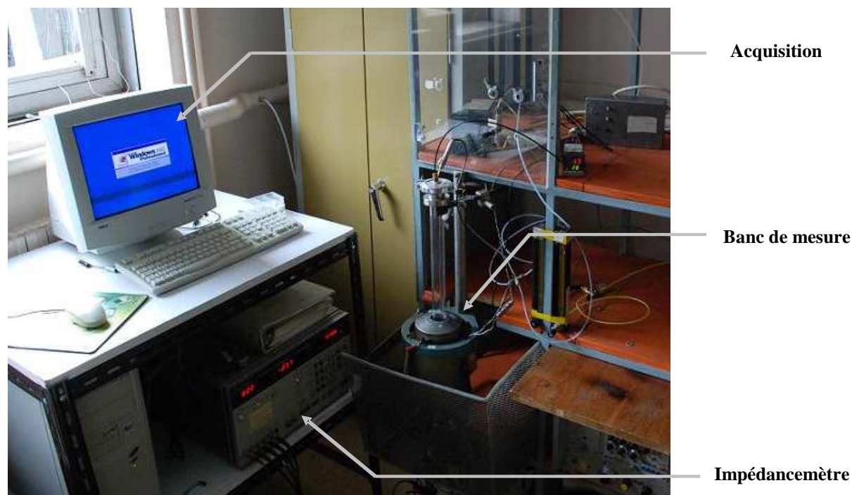
Figure II-11. Banc de mesure par spectroscopie d'impédance complexe HP4192A
