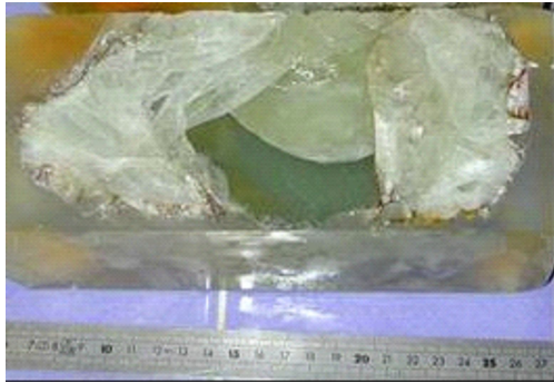
Figure I - 18 : photographies du réseau de fissures contenu dans des verres archéologiques (à gauche) et dans un colis de verre R7T7 (à droite).
