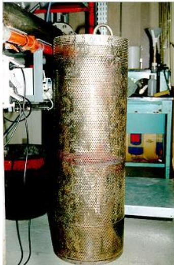
Figure I - 10 : image d'un colis de verre de type R7T7 dans un panier percé.
