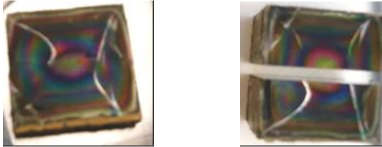
Figure III - 25 : photographie des surfaces internes de la fissure modèle horizontale supérieure.
