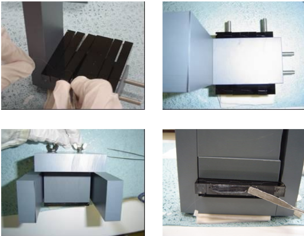
Figure III - 29 : photographies du montage des colonnes constitutives du réseau de fissures de l'expérience intégrale.
