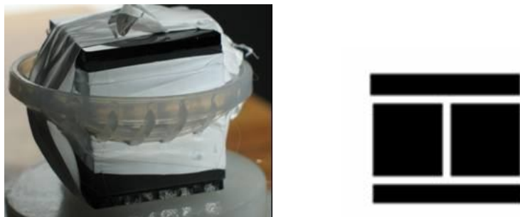
Figure III - 18 : réseau de trois fissures simples : photographie (à gauche) et représentation schématique du réseau (à droite).
