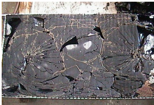
Figure I - 13 : photo de la demi coupe longitudinale restante d'un colis de verre de type R7T7 (H95CV07).
