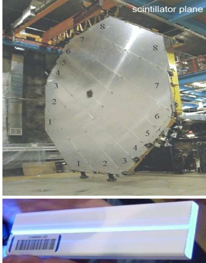
FIG. 2.9 : Photo (en haut) du détecteur proche composé de plans de scintillateur plastique. Un barreau de scintillateur plastique et sa fibre WLS sont présentés sur la figure du bas.
