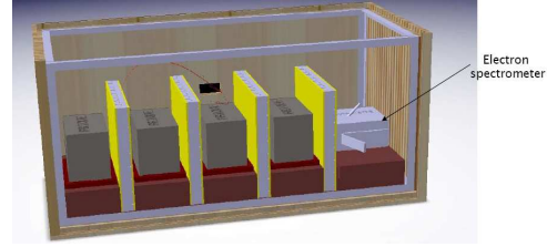
FIG. 6.6 : Vue de côté du miniTT. On distingue le spectromètre à électrons servant à l'étalonnage du dernier mur.
