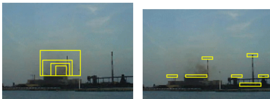
FIG. 5.4 – Disposition des zones de détection du système sur une usine de type aciérie. À gauche, les zones de détection sont positionnées de façon à analyser l'évolution d'un rejet survenant au niveau d'une source donnée. À droite, il y a autant de fenêtres de détection que de zones où peuvent survenir des rejets de fumée.
