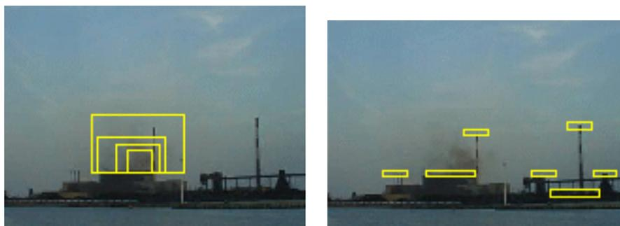
FIG. 5.4 – Disposition des zones de détection du système sur une usine de type aciérie. A gauche, les zones de détection sont positionnées de façon à analyser l'évolution d'un rejet survenant au niveau d'une source donnée. A droite, il y a autant de fenêtres de détection que de zones où peuvent survenir des rejets de fumée.
