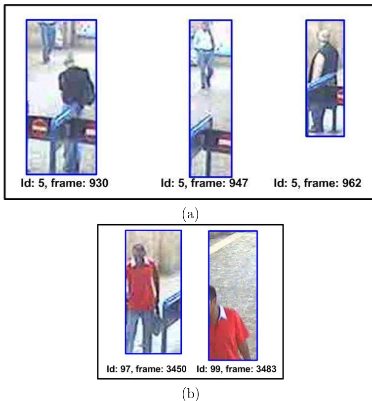
FIG. 6.13 – (a) un exemple de confusion d'étiquette : trois personnes réelles sont détectées et suivies comme une seule personne ; (b) un exemple de persistance d'étiquette : une personne est détectée et suivie comme deux personnes différentes.
