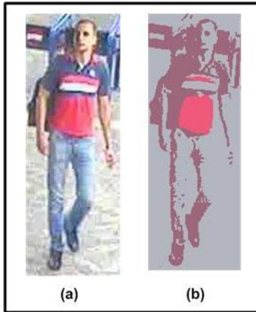
FIG. 4.5 – (a) blob d'une personne détectée ; (b) et projection de 3 couleurs dominantes sur le blob.
