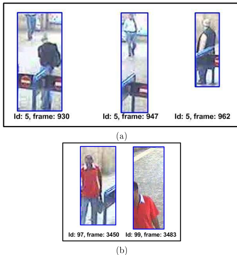
FIG. 6.13 – (a) un exemple de confusion d'étiquette : trois personnes réelles sont détectées et suivies comme une seule personne ; (b) un exemple de persistance d'étiquette : une personne est détectée et suivie comme deux personnes différentes.
