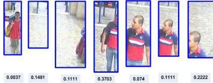
FIG. 4.15 – Blobs représentatifs associés à leurs poids détectés par la méthode basée sur le changement d'apparence.
