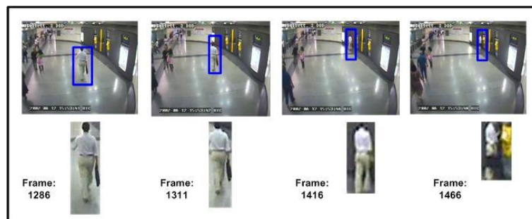
FIG. 6.4 – Une personne détectée et suivie pendant 905 frames de la vidéo CARE_5, 4 blobs représentatifs sont identifiés pour cette personne. Les images en haut sont les images de la scène avec la présence de la personne. Les images en bas sont les blobs représentatifs de la personne. Tous les quatre blobs représentatifs sont pertinents. Ils représentent des aspects différents de la personne.
