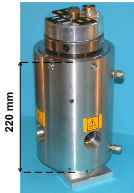
FIG. 2.1 – Autoclave servant aux mesures d'absorption X
