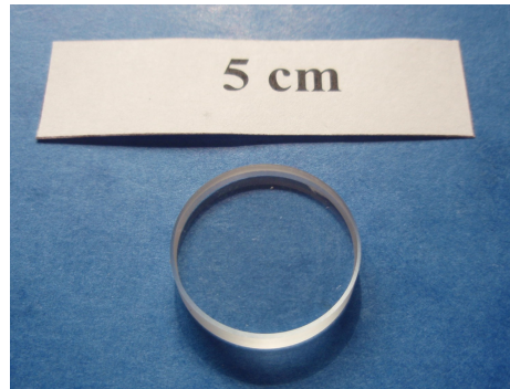
FIG. 2.15 – Photographie d'une fenêtre de saphir de l'autoclave servant aux mesures de Raman optique. Le diamètre de cette fenêtre est de 19 mm, et l'épaisseur de 4 mm.
