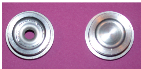
FIG. 2.10 – Photographie de fenêtres de béryllium de l'autoclave servant aux mesures d'absorption X, à gauche après une explosion à une pression d'eau de 4000 bar, à droite une fenêtre intacte. Ces fenêtres ont une épaisseur de 1,5 mm et un diamètre de 19 mm.
