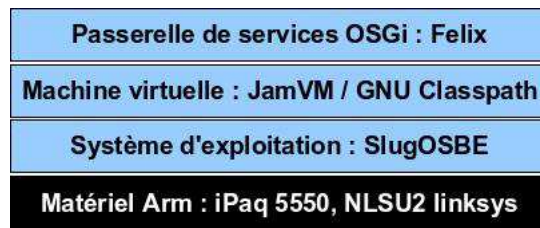
FIG. 2.6 – Pile d'exécution embarquée pour OSGi
