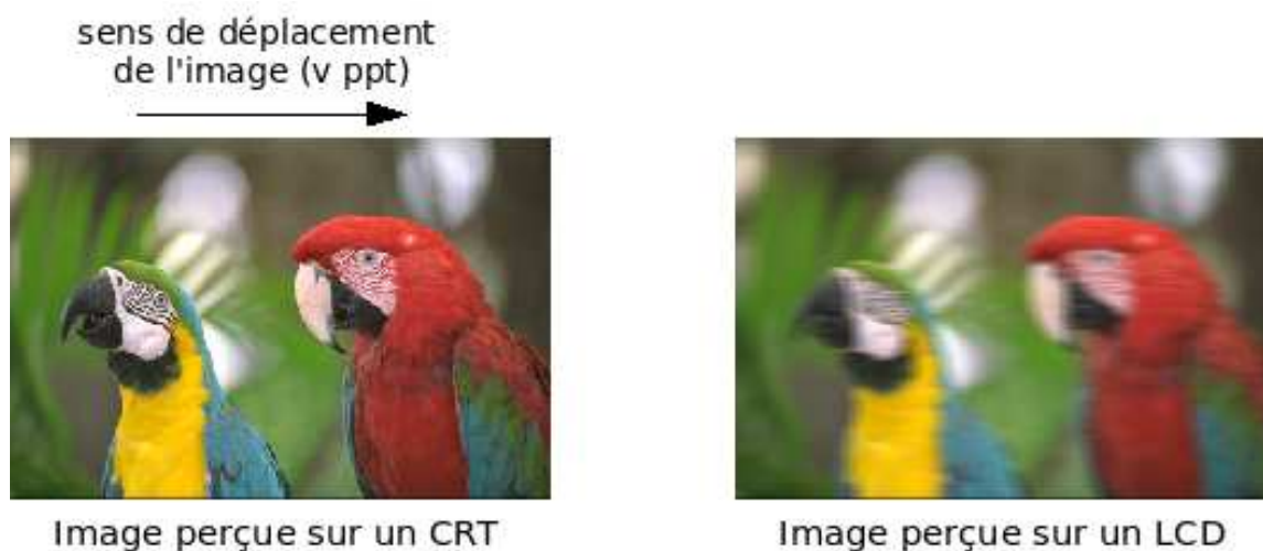
FIG. 2.15 – Simulation de l'effet échelon sur une image naturelle
