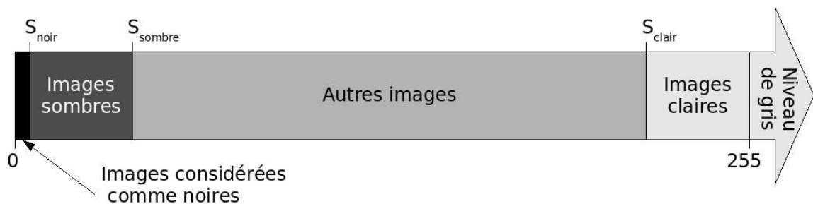
FIG. 10.6 – Répartition des types d'images selon \bar{I} et les seuils mis en jeu
