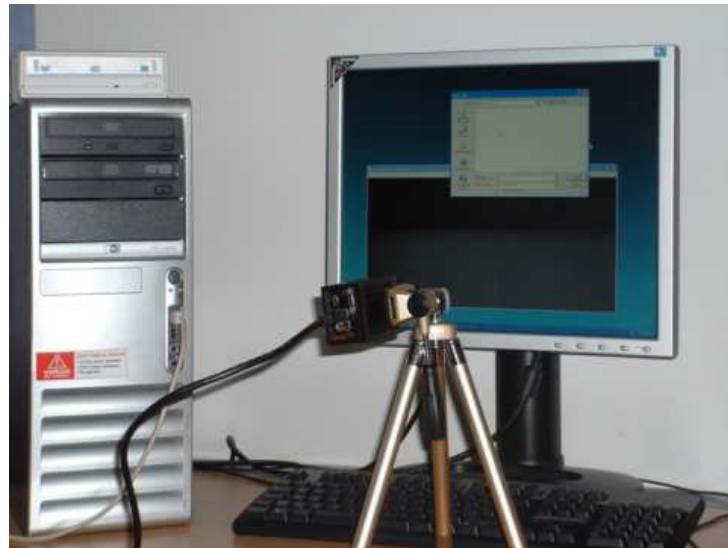
FIG. 4.10 – Système de mesure de temps de réponse basé sur une caméra linéaire
