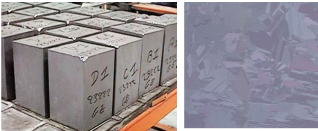
Figure III-14. Blocs de silicium à gauche, plaquette à droite [54].
