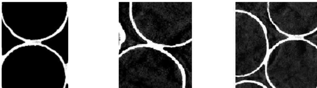
Fig. VI.5 : Morphologie des contacts arrondis d'un empilement ATECA.
