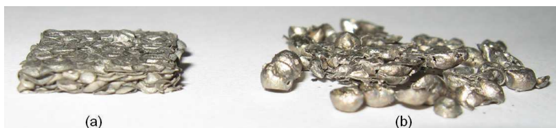
Fig. IX.2 : Photographies des échantillons à la fin d'un essai de compression (a) Empilement PLANSEE . (b) Empilement ATECA . On observe que l'échantillon PLANSEE conserve sa cohésion alors que l'empilement ATECA se rompt laissant les sphères se détacher.
