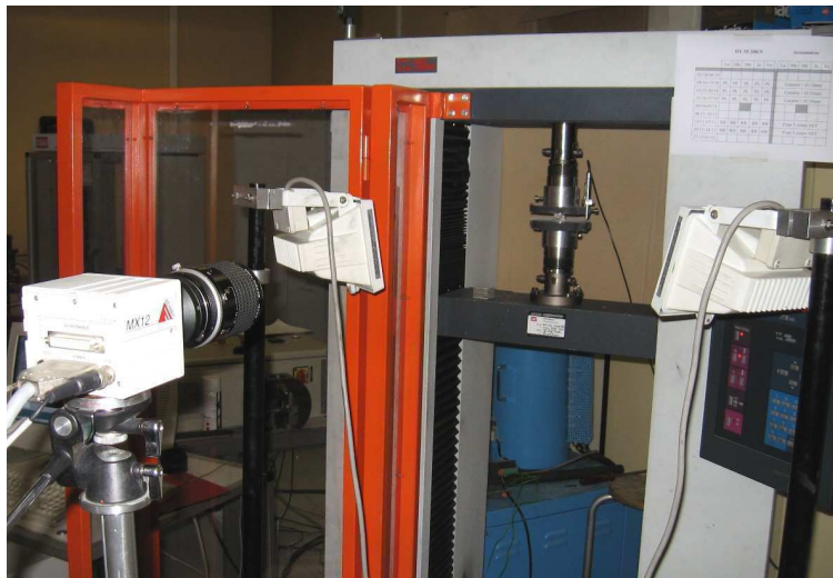
Fig. IV.24 : Photographie du dispositif de compression sur la machine ADAMEL DY35 .
