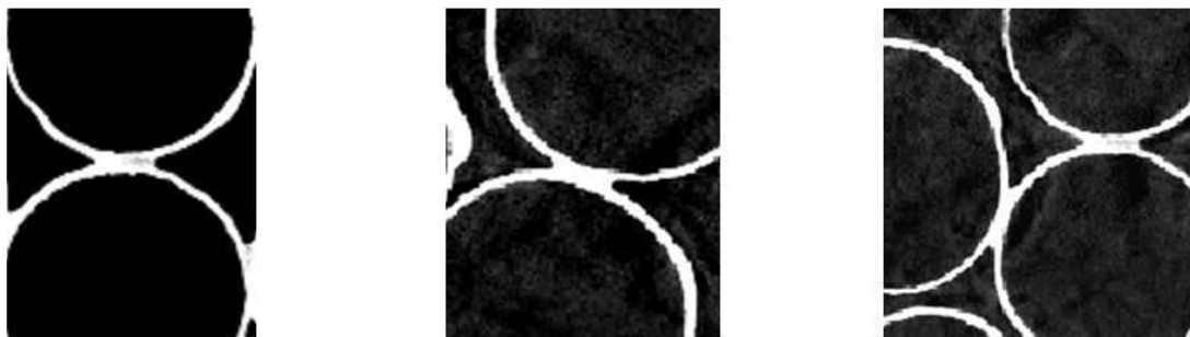
Fig. VI.5 : Morphologie des contacts arrondis d'un empilement ATECA.
