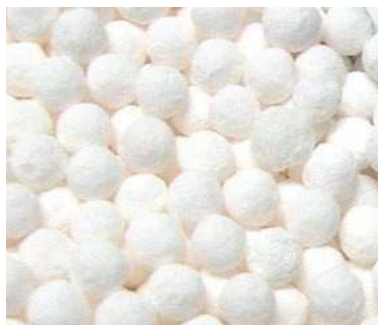
Fig. II.2 : Empilements de sphères creuses en céramique produits par ATECA.
