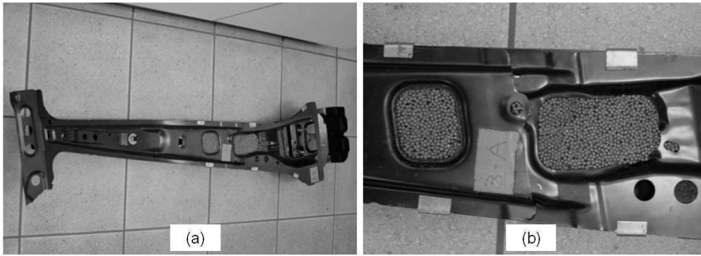
Fig. II.5 : B-pillar d'une voiture de tourisme. (a) Pièce originale. (b) Pièce partiellement remplie de sphères creuses. Extrait de [69].
