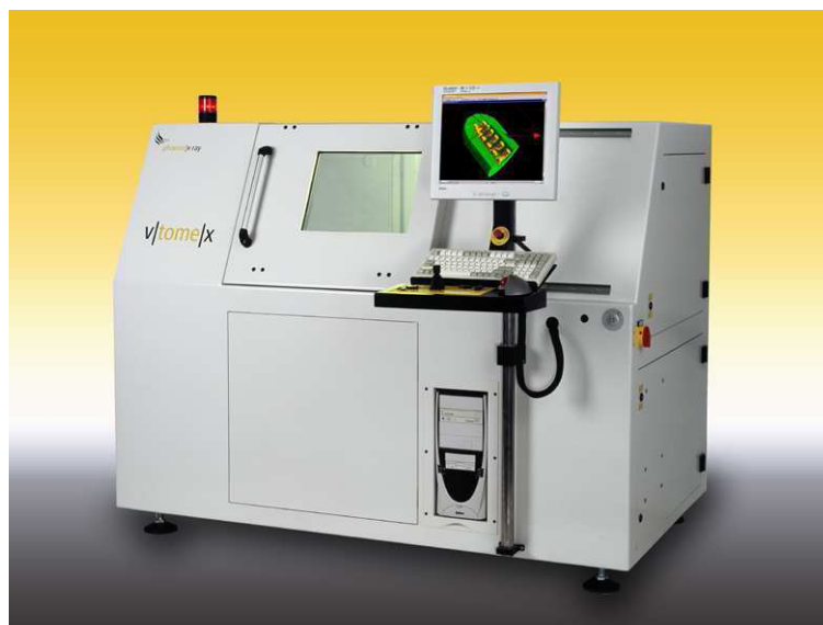
Fig. IV.5 : Tomographe du laboratoire MATEIS de l'INSA Lyon.
