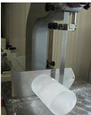
Dans un premier temps, une tranche de monocristal est découpée à la scie et l'orientation de l'axe cristallographique  $c$  est déterminée sous lumière polarisée (Lliboutry (1964)). Une face perpendiculaire à l'axe  $c$  est soigneusement préparée à la scie et au papier abrasif. Cette face servira de référence.
