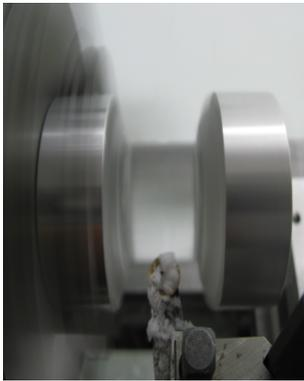
Après solidification, l'échantillon, solidaire des deux mors est usiné au tour pour lui donner sa forme cylindrique. On laisse ensuite l'échantillon sublimer à  $-15^{\circ}\text{C}$  afin de supprimer les irrégularités de surface induites par la dernière étape d'usinage. Une ligne témoin est tracée le long d'une génératrice du cylindre pour vérifier l'homogénéité de la déformation à l'échelle macroscopique.
