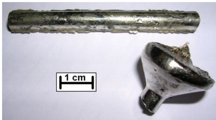
Figure III-1 Barreau de verre métallique Mg_{65}Cu_{25}Gd_{10} obtenu par injection dans un moule de cuivre de diamètre 6mm
