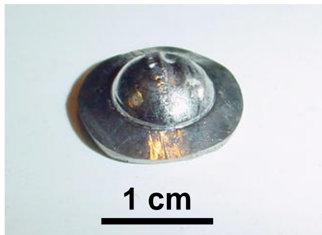
Figure VII-3 Essai d'emboutissage à 155°C d'une plaque de 2mm d'épaisseur du verre Mg_{65}Cu_{25}Y_{10}
