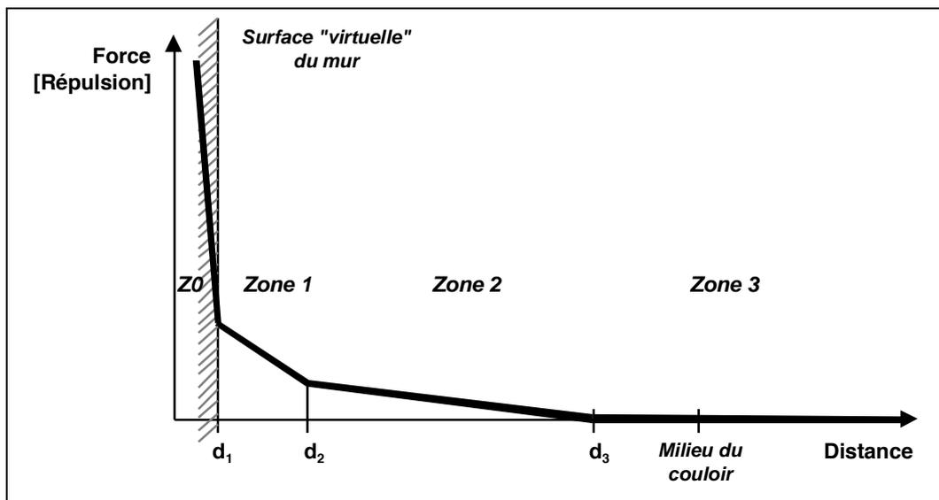
Figure 39 : Fonction d'interaction Individu / Mur
