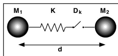
**Figure 40 : Interaction de type butée élastique**
