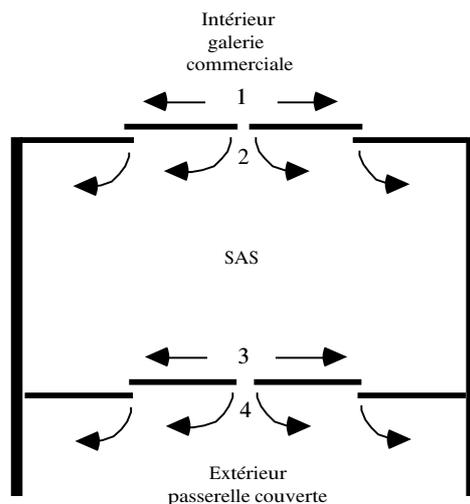
**Figure 26 : Schéma de fonctionnement des portes automatiques**
