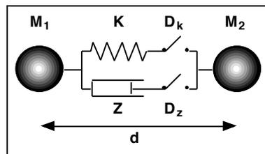
Figure 18 : Liaison de type butée viscoélastique
