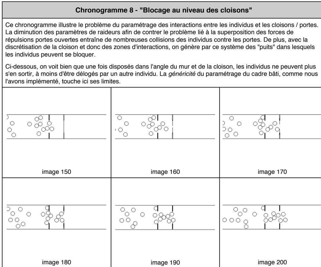
**Figure 53 : Chronogramme "blocage au niveau des cloisons"**
