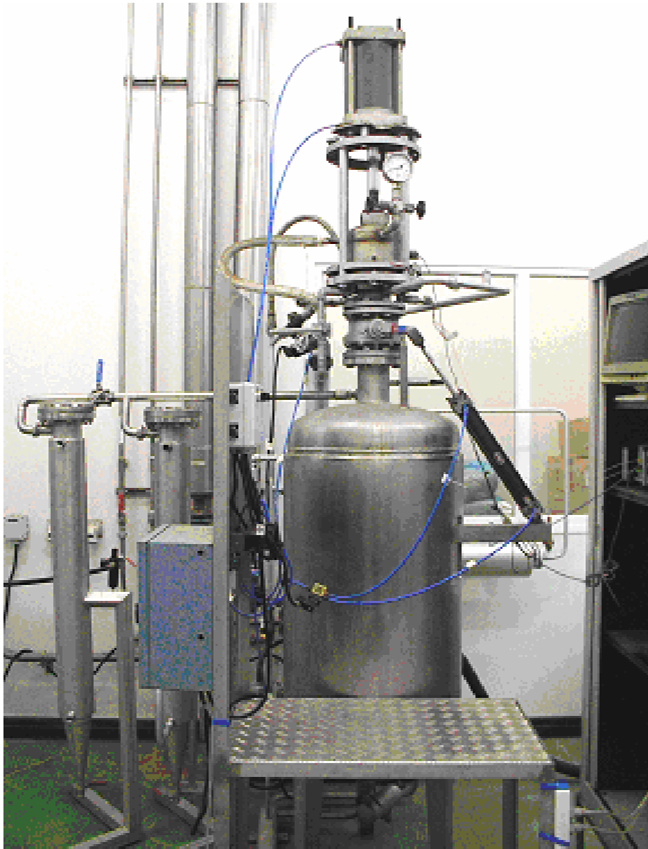
Figure II-5: Photo du réacteur de traitement DIC : On distingue les parties principales qui le composent. A droite, l'ordinateur équipé de cartes électroniques permettant l'acquisition des données
