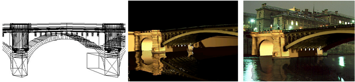
Fig. 3.19. : Différentes étapes de production d'une image de synthèse, modélisation morphologique, simulation lumineuse du pont avec création de reflets et incrustation photographique 229
