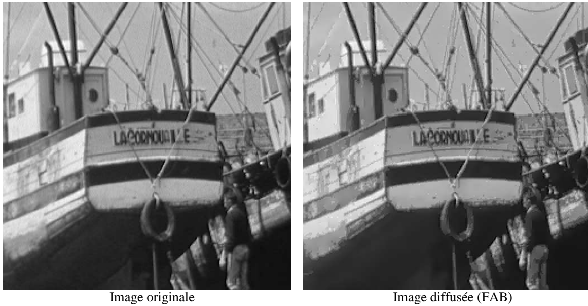
Fig. 2.12 Effets de la diffusion FAB sur l'image « La Cornouaille », t=10, K_f=8, K_b=20, w=8 .
