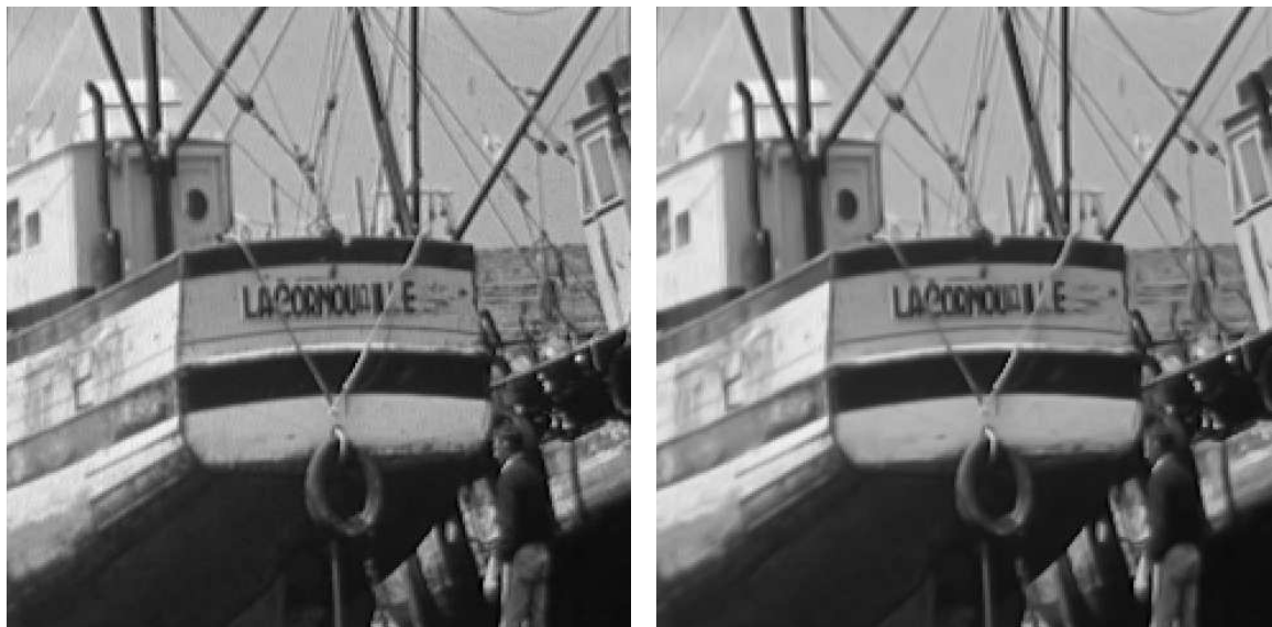
Fig. 2.28 Filtrage GLE amélioré sur l'image « La Cornouaille » (image originale à gauche, image filtrée à droite, \alpha=0 , \sigma_U=50 , \sigma_N=0,5 , \sigma_T=2 ).
