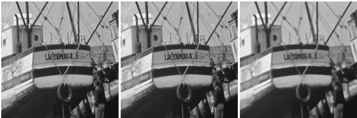
Fig. 2.16 Diffusion EED sur l'image « La Cornouaille » (à gauche). Au centre : K=5, \sigma=0,5, t=2,5 ; à droite : K=5, \sigma=0,5, t=5 .
