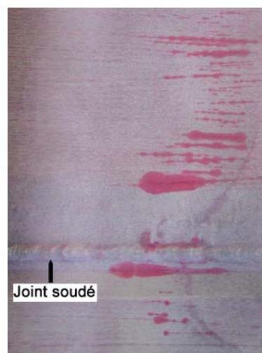
**Fig.I-23: Résultat d'essai INTHERPOL après 264 000 cycles [55]**
