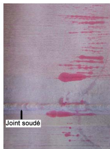
Fig.I-23: Résultat d'essai INTHERPOL après 264 000 cycles [55]
