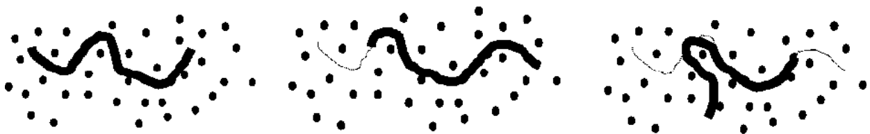
Figure 5A.2 : Modèle de reptation simple d'une macromolécule cylindrique.
